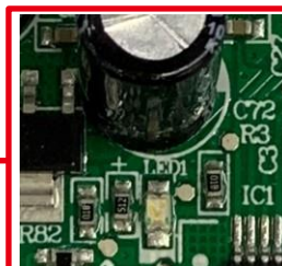
LED1: індикатор несправності приводу
